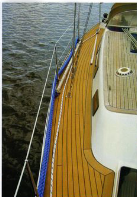
Seacork bringt klassische Kork-Struktur aufs Deck (links). Flexiteek aus PVC (rechts) sieht wie Teak aus, wird aber nicht grau. So ein Materialmix sieht bald komisch aus
