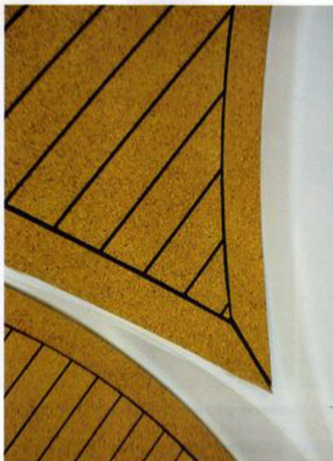
Seacork bringt klassische Kork-Struktur aufs Deck (links). Flexiteek aus PVC (rechts) sieht wie Teak aus, wird aber nicht grau. So ein Materialmix sieht bald komisch aus
