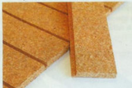
Le revêtement de pont Seacork est disponible sous deux formes, en plaques rainurées de 1025 x 517 mm, ou en lames de 2 m, pour 8 mm d'épaisseur et une largeur de lame de 45 à 100 mm. Pour les planchers intérieurs ou les petites unités, on peut aussi utiliser du 4 mm, disponible en plaques uniquement mais, pour un lattage courbe par exemple, les lames s'extraient facilement au cutter.
